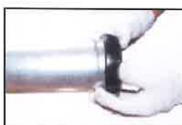
Rys. 1. Złącze zamontowane na przewodzie rurowym (na przykładzie złącza elastycznego, typu 1212)
